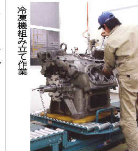
冷凍機組み立て作業
